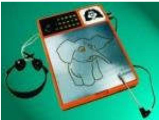
*Предназначен для упражнений при амблиопии, сочетающих зрительные раздражения со звуковыми, кинестетическими и тактильными при центральной монокулярной фиксации, с целью восстановления и закрепления правильной монокулярной локализации.*
